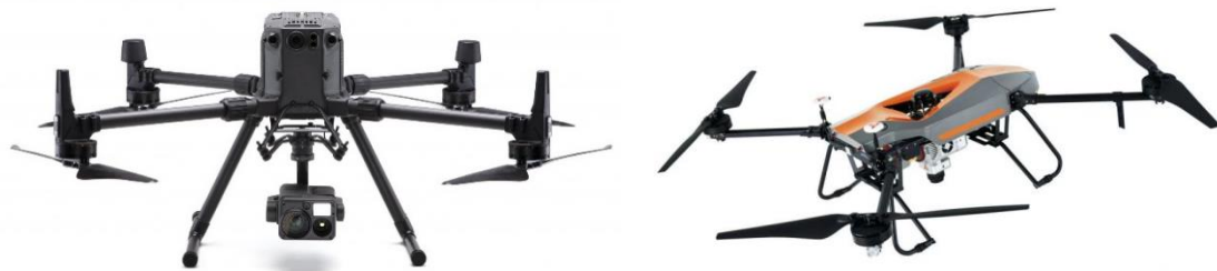
รูปที่ 2-12 ตัวอย่างอากาศยานไร้คนขับชนิดปีกหมุน (Multi-Rotor)
