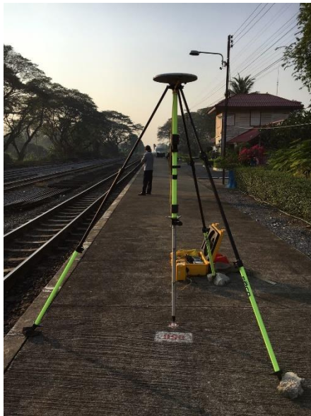
รูปที่ 2-16 ตัวอย่างภาพอุปกรณ์รับค่าพิกัดดาวเทียม GNSS และงานรับสัญญาณแบบ Geodetic
